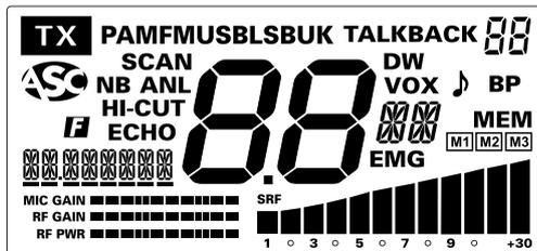
Le bargraphe principal *visualise* le niveau de réception et le niveau de puissance émise. Les petits bargraphes *visualisent* les niveaux du Mic Gain, RF Gain et RF Power.
