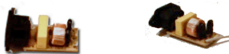
Avant de procéder à des tests, il faut mettre ce petit module dans un boîtier, de préférence métallique, pour faire blindage aux parasites, mais si vous n'en avez pas à disposition, un boîtier plastique conviendra (d'autant qu'il sera parfaitement isolé).
