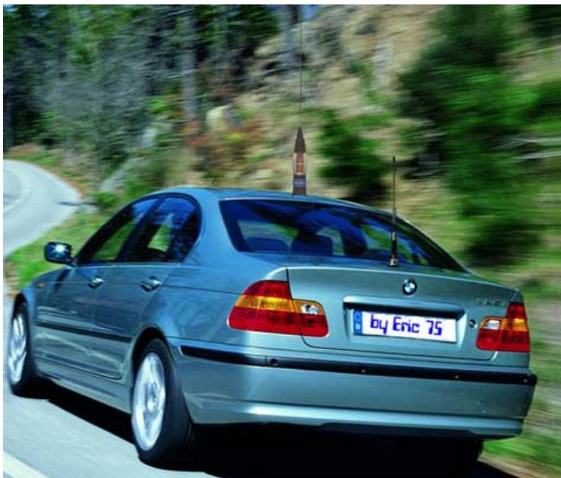
Comme on peut le voir, sur cette image, la belle berline allemande, est équipé d'une antenne pour le téléphone, qui est placé sur le pavillon arrière, et l'antenne CB est placée au-dessus de celle-ci, sur le toit du véhicule. De cette façon, chacun des émetteurs pourra travailler sans perturber l'autre.
